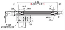
\*L≥340 时每个槽中均入了3个螺帽;在需要带螺帽插入用沉孔时,请通 过追加加工进行指定。
