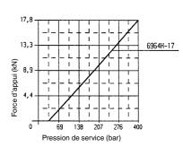
Modification de longueur élastique de 0,004 mm/kN en cas de charge.
