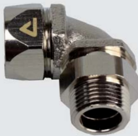
ISO drehbare, 90° Verschraubung, Aussengewinde, Messing-vernickelt, IP 65 / IP 67. (einschl. Einschraubset)
