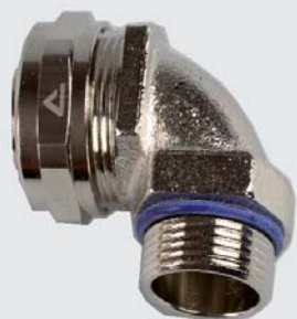
Raccordo IP 68 compact Pg maschio 90° in ottone nichelato (incluso adattatore)
