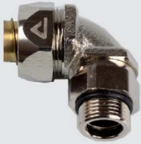
Raccordo ISO maschio 90° girevole in ottone nichelato (incluso adattatore)
