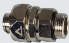
Raccordo ISO maschio diritto girevole in ottone nichelato, IP 65/ IP 67 (incluso adattatore)
