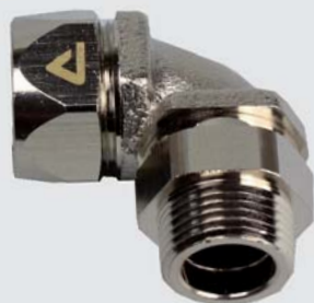
Raccordo ISO maschio 90° girevole in ottone nichelato IP 65 / IP 67 (incluso adattatore)
