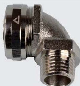
Raccordo IP 68 compact NPT maschio fisso 90° in ottone nichelato (incluso adattatore)
