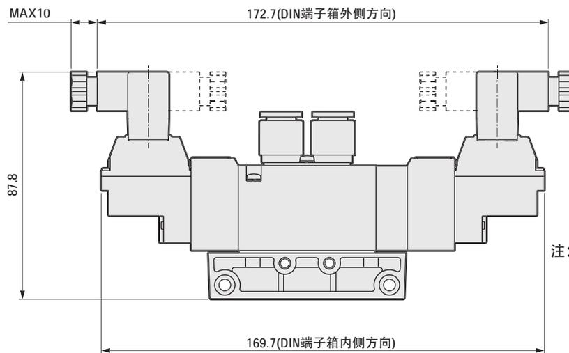
注：DIN端子箱组件向内安装发货。
