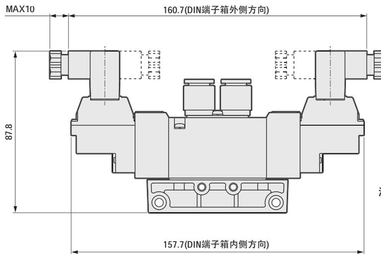
注: DIN端子箱组件向内安装发货。
