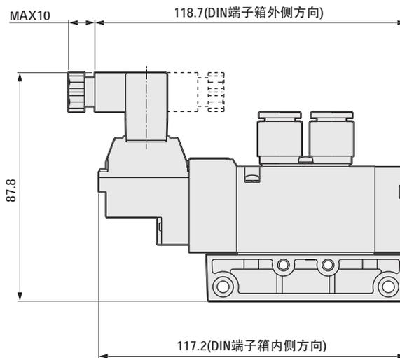
注：DIN端子箱组件向内安装发货。
