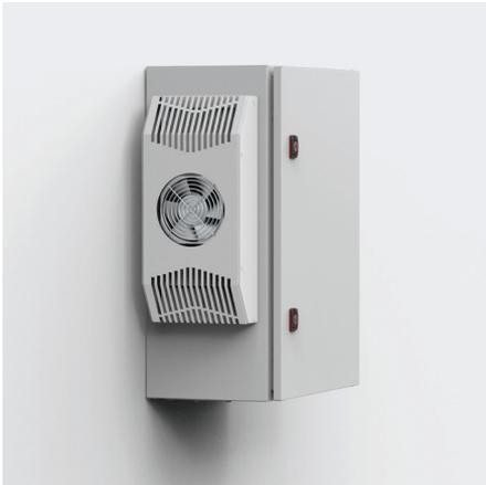
**Descripción:** Nuestros refrigeradores compactos y de perfil bajo utilizan el efecto Peltier para enfriar pequeños armarios de interior y exterior. No se necesitan condensadores, compresores ni filtros, lo que convierte al equipo en una solución segura para entornos exigentes con requisitos de bajo mantenimiento.
