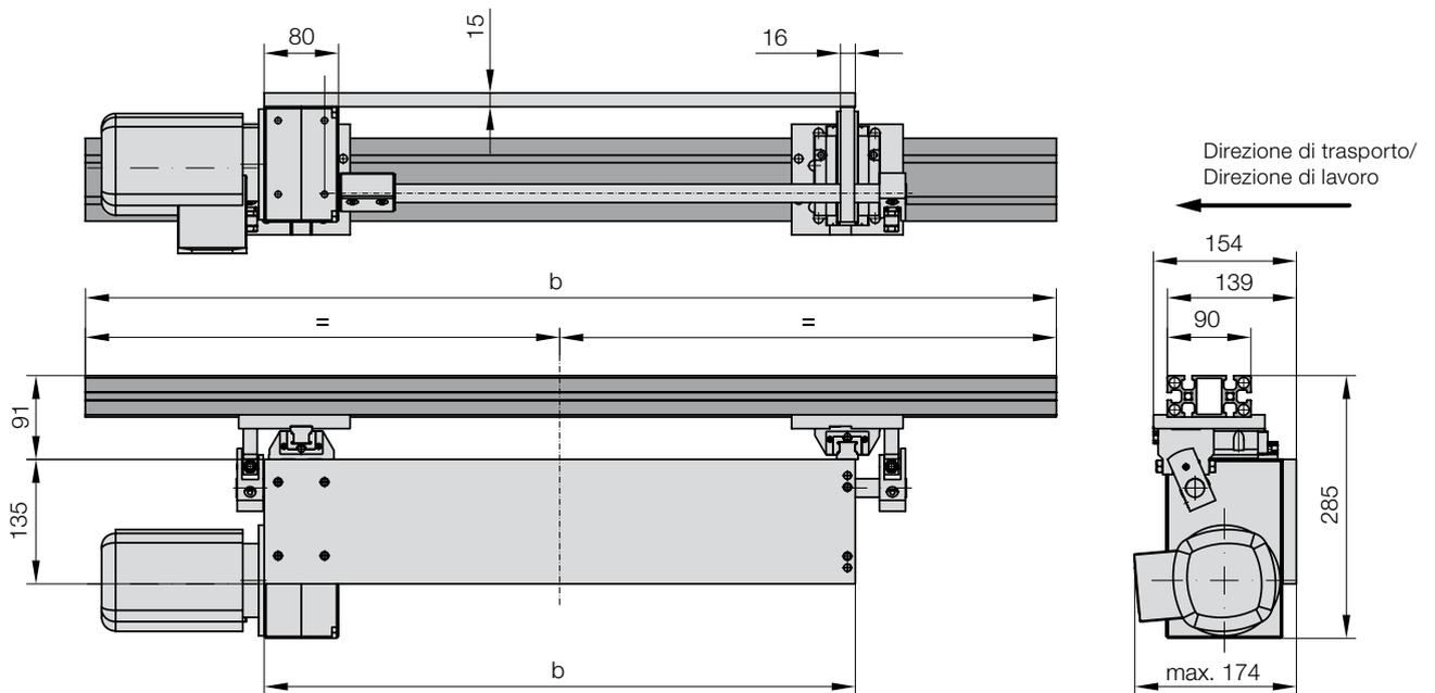
2299.121. Trasportatore elettromeccanico, posizione riduttore verticale, 2 slitte, con profilo e supporto
