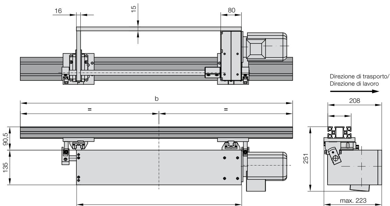
**2299.122. Trasportatore elettromeccanico, posizione riduttore orizzontale, 2 slitte, con profilo e supporto**
