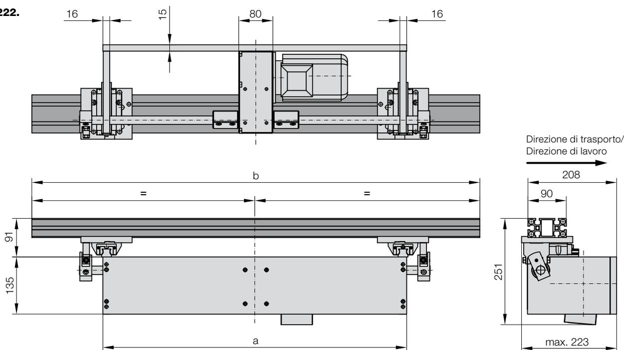
**2299.222. Trasportatore elettromeccanico, posizione riduttore centro orizzontale, 2 slitte, con profilo e supporto**
