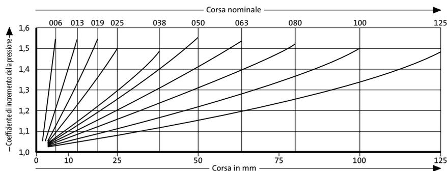
Il coefficiente di incremento della pressione è valido per i cambiamenti di volume del gas derivanti dalla corsa senza tenere conto degli altri fattori coinvolti!
