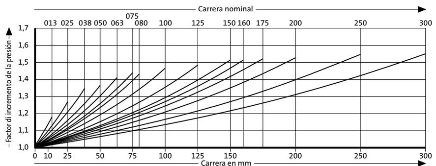
El factor de incremento de la presión es válido solamente para el desplazamiento del volumen de gas en relación a la carrera, sin otras influencias!
