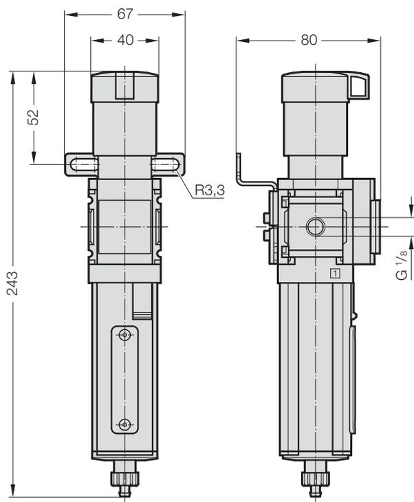
Druckluft Wartungseinheit zur Reinigung und Regulierung der Steuerluft des Patronenventils in der aktiven Gasdruckfeder.
