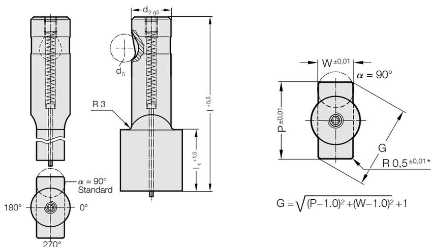
**2755. Punzón de corte de cambio rápido, con el diámetro de corte mayor que la caña, rectangular con radio, con expulsor, para trabajos duros**
