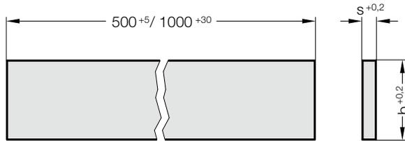
**2923.2436. Acciaio piatto di precisione e acciaio quadro con sovrametallo, DIN 59350**
