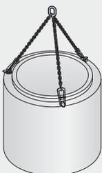
Schachtunterteile werden je nach Größe und Gewicht mit 3 oder 4 Kugelkopf-Transportankern versetzt.
