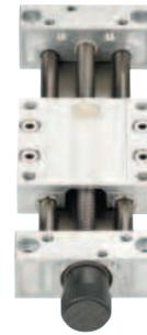
Die vorgespannten Lineareinheiten drylin® SLWE-PL (preload) bieten dem Anwender eine Zusatzoption zur Standardbaureihe. Zwei mit Federn vorgespannte Muttern reduzieren das Axialspiel. Die Spindel wird in Ihren Lagerungen radial und axial leicht vorgespannt. Das Schlittenspiel ist manuell einstellbar.
