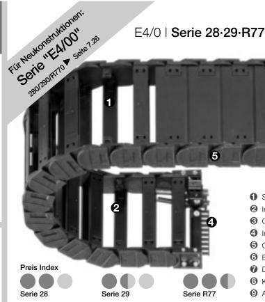
3 Stege bei E-Kette® beidseitig herausnehmbar Innenradius Deckel herausnehmbar Geschlossene und offene Bereiche kombinierbar Integrierte Zugentlastung möglich 6 Optimierte Gleitflächen 0 Breite, abgerundete Öffnungsstege - kabelschonend 7 Deckel bei Energierohr schwenkbar und herausnehmbar KMA Anschlusselemente mit "Rundum" Befestigungsmöglichkeit Anschlusselemente starr oder pendelnd lieferbar
