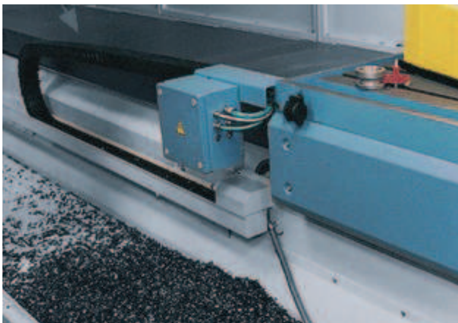
E2 E-Rohre in einem Bereich mit heißen Spänen in einer Werkzeugmaschine
