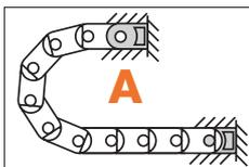
Diese Befestigungsvarianten ergeben sich automatisch bei der Wahl des KMA-Anschlusselements. Für die **vormontierte** Variante bitte den Index **A** anfügen ▶ z.B. **24001.02.12.ZBA**
