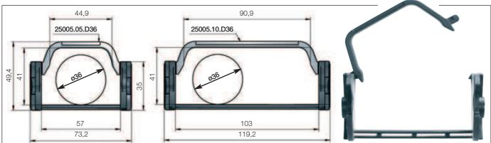
Bügelketten nur für Serie 2450 - enorme Vergrößerung des Innenraums, schonende Führung von Schläuchen Geeignet für Schläuche mit einem Außendurchmesser von max. 36 mm.
