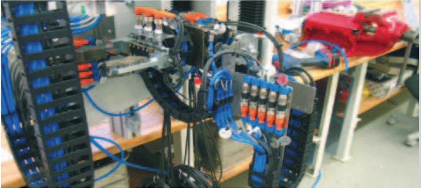
E2/000 - schmutzunempfindliche E-Kette®, die Bauraum spart - hier in einer Bearbeitungsmaschine für Werkstücke
