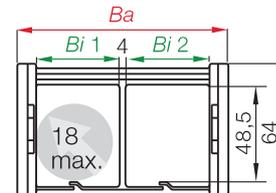
Serie Z300 - im Innenradius zu befüllen mit 3-Kammersystem
