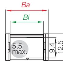
Serie Z045 - im Innenradius zu befüllen mit 2-Kammersystem
