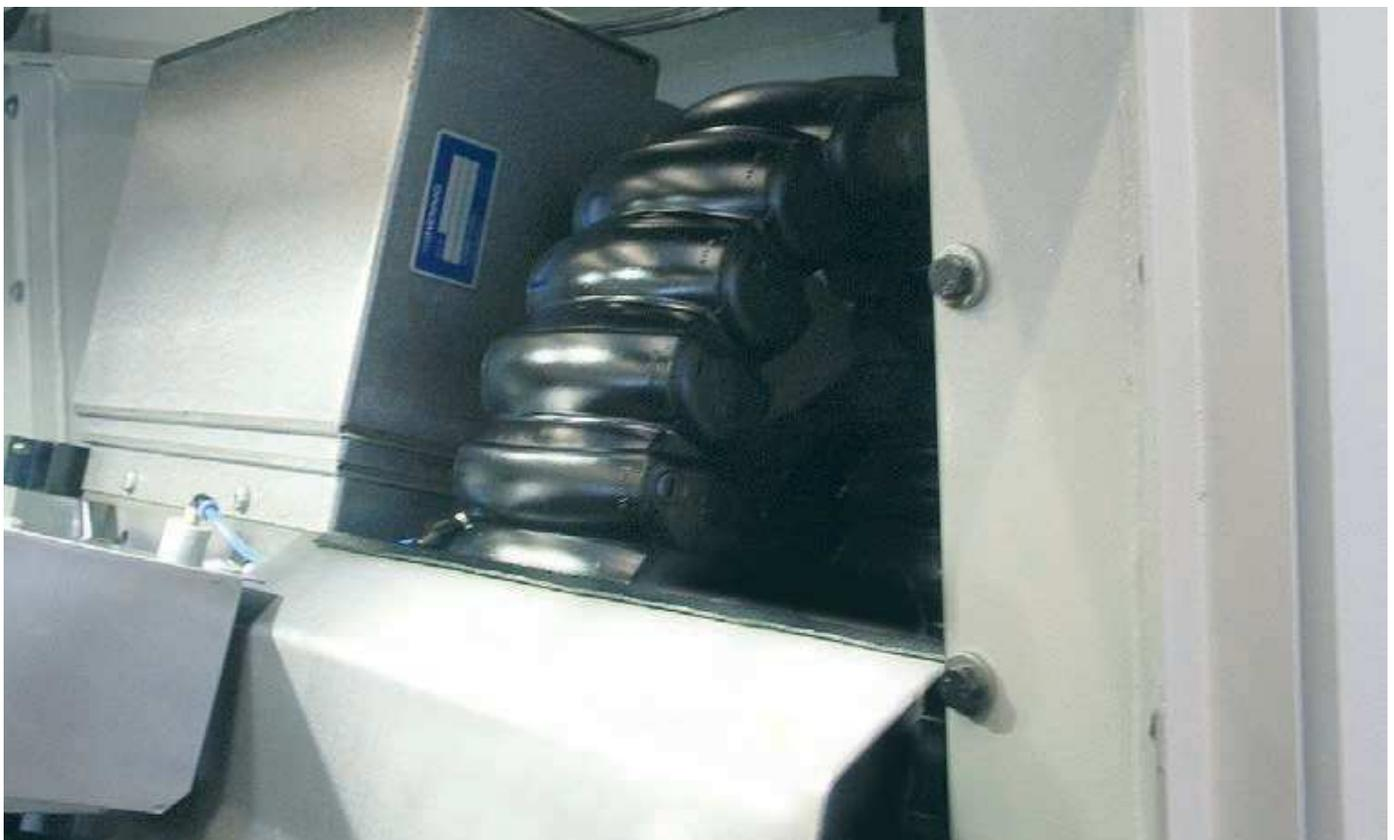
Trotz begrenztem Bauraum kommt das RX e-rohr-Rohr in dieser kompakten Drehmaschine zum Einsatz, hier mit rückwärtigem Biegeradius (RBR)
