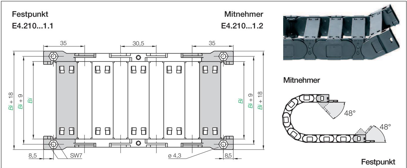
**KMA pendelnd** | Rundumbefestigung. Ideal für freitragende und gleitende Anwendungen
