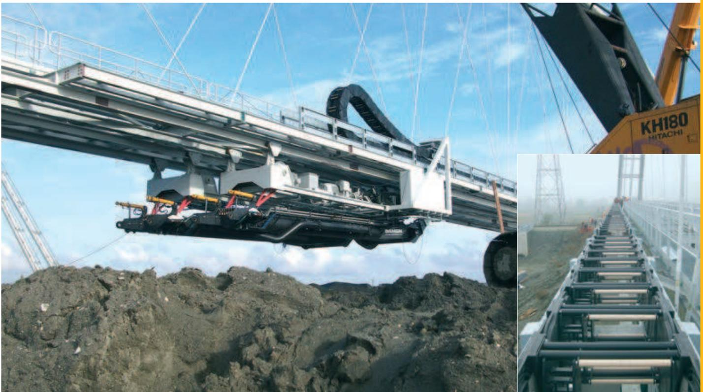
Weltweit größte Polymer e-kette®: Leichter als vergleichbare Stahlketten bewegt sie mühelos mehr als 100 kg Füllgewicht pro Meter auf 138 m Verfahrweg
