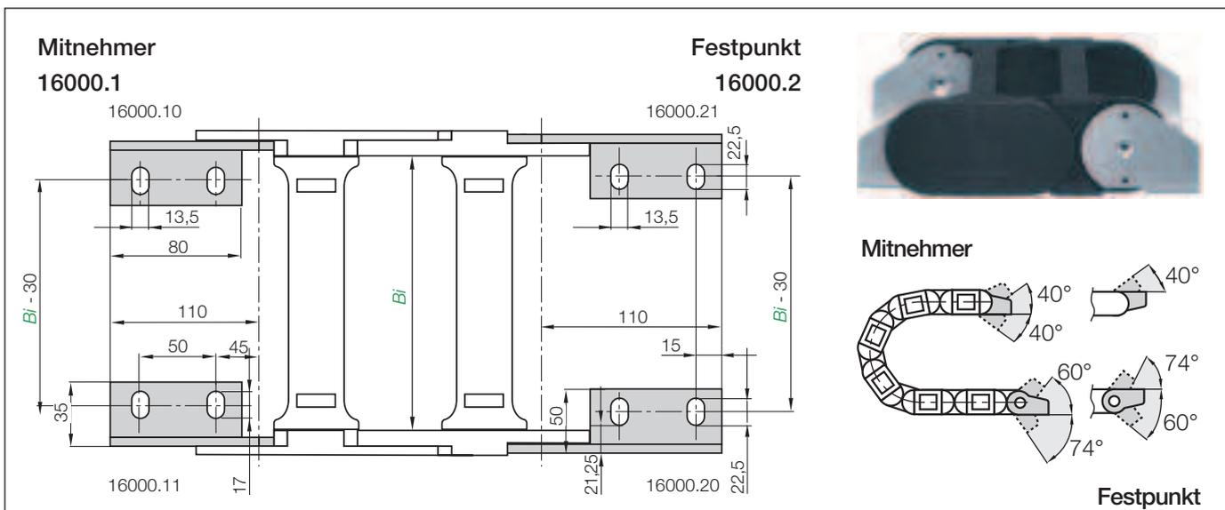
**Stahl pendelnd** | Für freitragende, gleitende, stehende und hängende Anwendungen
