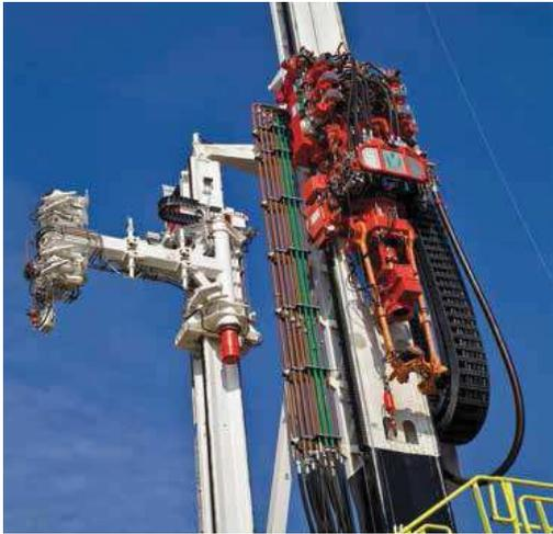
Kompakte Konstruktion, kundenspezifisch projektiert - zwei E4.112 e-ketten® von rund zwölf Metern Länge sind ineinander angeordnet und tragen sehr hohe Lasten
