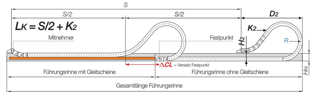
**Hinweis:** Wir empfehlen die Projektierung einer derartigen Anlage von unseren Technikern ausführen zu lassen. Bei Verfahrswegen zwischen 7 und 10 m empfehlen wir eine e-kette® mit größerer freitragender Länge.
