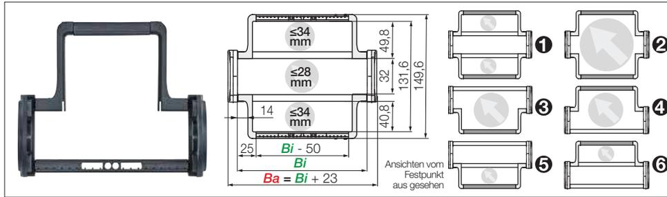
Bügel mit flexibler Breite | Schonende Führung von Schlauchanwendungen
