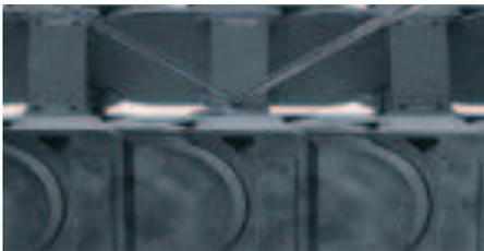
**Öffnen E-Kette®:** Die Nut des Öffnungssteges mit einem Schraubendreher senkrecht eindrücken. Mit Hebelbewegung (gegen das Horn) lösen
