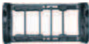
Standardmäßig werden igus® Trennsteg jedes 2. Kettenglied montiert! **Hinweis:** Seitenabstand von min. 33 mm (E-Rohr) und min. 16 mm (E-Kette®) beachten!
