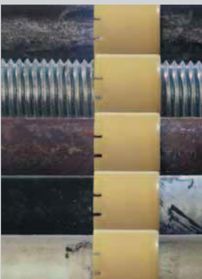
Bild 35.1: iglidur®-PEP-Lager laufen unabhängig vom Werkstoff der Welle.
