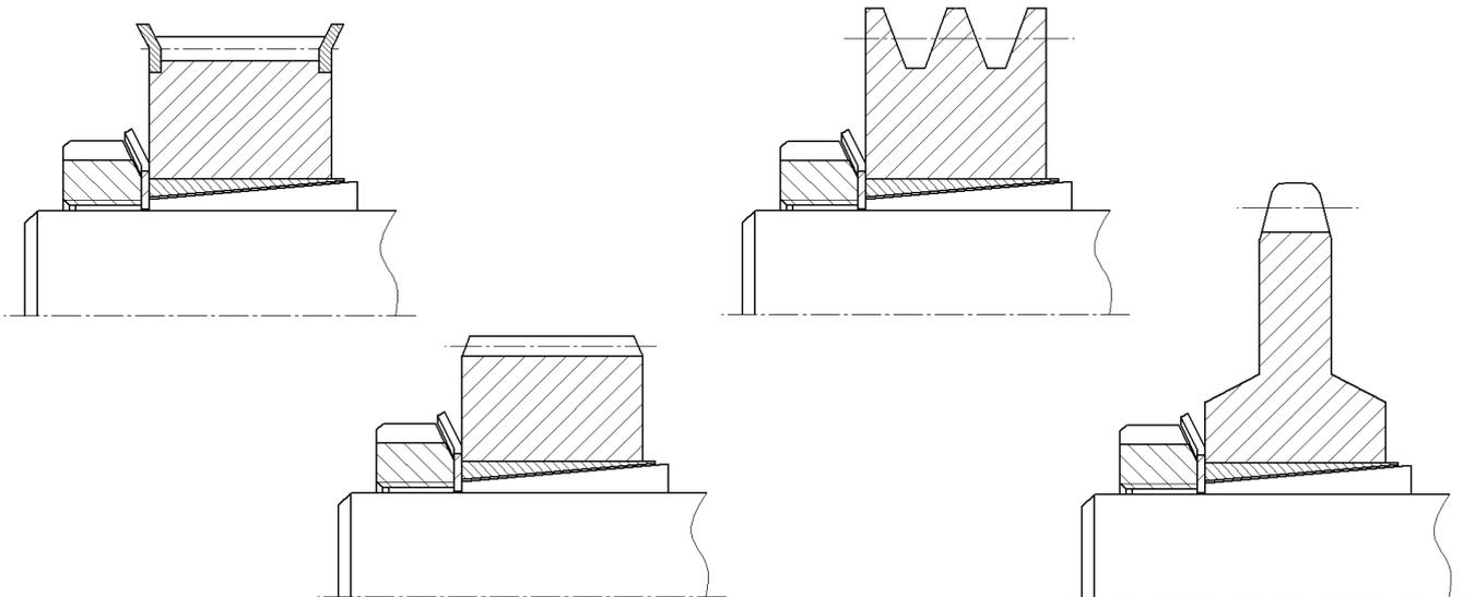
Der **KBS 55 Spannsatz** ist eine reibschlüssige, lösbare Welle-Nabe-Verbindung für Zylindrische Wellen und Bohrungen ohne Passfeder.
