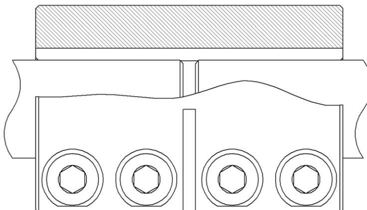
Die **starre Wellenkupplung KBST-VA** ist eine reibschlüssige, lösbare Welle-Welle-Verbindung für zylindrische Wellen mit und ohne Passfeder.
