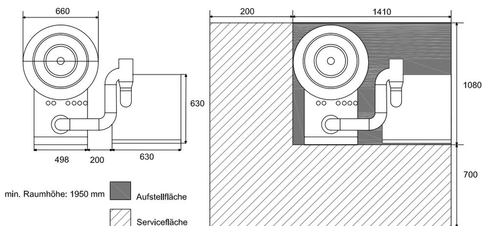
Die Brennstoffzelle kann sowohl links als auch rechts von der Speicher-Kessel-Einheit montiert werden.
