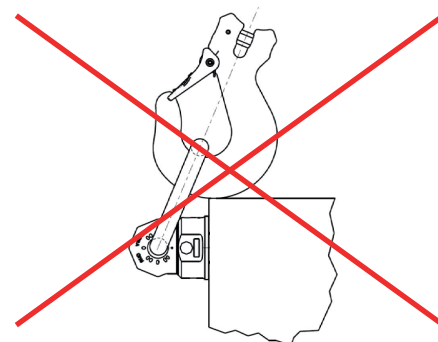
Abb. 2: Verbotene An- bzw. Auflage an Kanten
