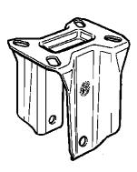
Supporto costituito da una forcella in lamiera di acciaio zincato elettroliticamente
