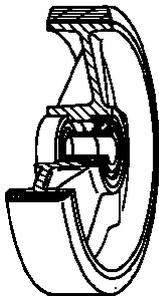
**Rivestimento:** in poliuretano “TR”, durezza 95 +/- 3 Shore A, ottime caratteristiche di scorrevolezza ed elasticità, alta resistenza ad usura e lacerazione.
