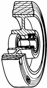
**Rivestimento:** Rivestimento costituito da un anello in gomma vulcanizzata "Sigma Elastic"; durezza 70 +/-3 Shore A.
