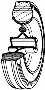
**Rivestimento:** Rivestimento costituito da un anello calettato in gomma standard antitraccia; durezza 80 Shore A.
