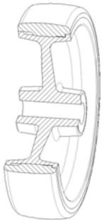
**Rivestimento:** in gomma termoplastica grigia antitraccia, durezza 85+/-4 Shore A, ottime caratteristiche di scorrevolezza ed elasticità.
