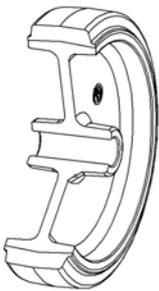
**Ruota:** Rivestimento costituito da un anello in gomma elastica blu antitraccia; durezza 70 Shore A.
