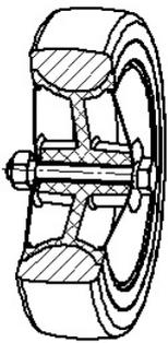
**Ruota:** rivestimento costituito da un anello in gomma antitraccia
