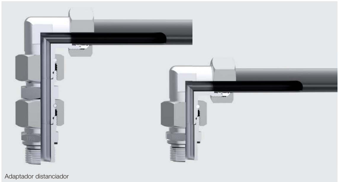
Adaptador distanciador con cono de obturación y junta tórica
